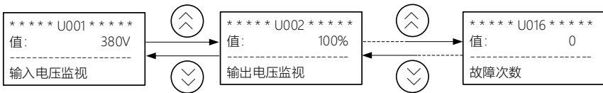
图 4.6 状态监视模式显示界面示意图
